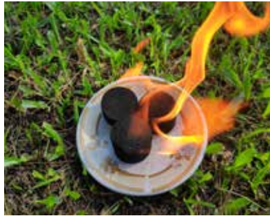
Gambar 10.10 Produk briket hasil pemanfaatan limbah cangkang kelapa sawit
